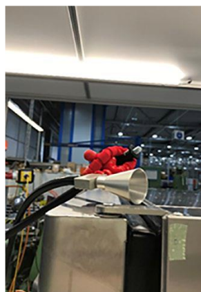
図6. Heracell Vios 160i CRの粒子濃度が最も高かった位置（MP3）。上側ドアヒンジ上の右上部
