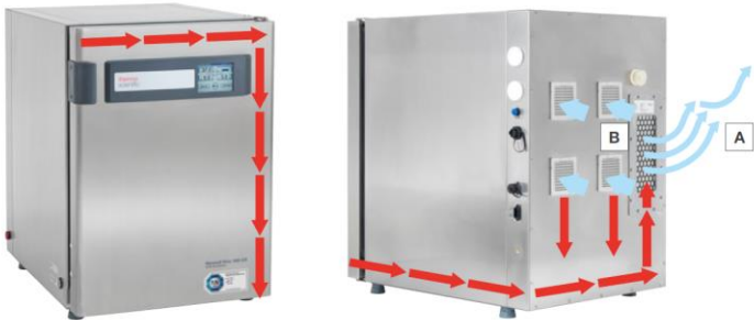
図 2.ISO14644-14: 2016 に従って行った CO 2 インキュベーターのクリーンルーム適合性試験の概要
