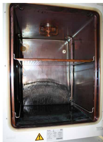
図 2. 数年使用した後の銅チャンバー内部
