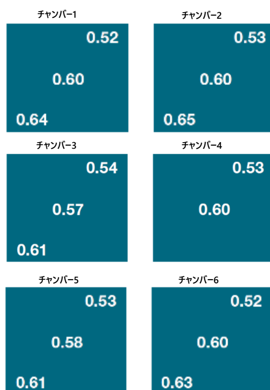
図 5：セルロッカーチャンバーでの蒸発による水分の損失は、蓋を開けたシァーレ全量 15 g に対し 0.6 g /日でした。図の各正方形は、セルロッカーシステムインキュベーターの 1 つのセルロッカーチャンバーを表し、その中の 3 つの数字は、3 つのシァーレそれぞれからの 24 時間での蒸発量を表します。これに対して、セルロッカーシステムを使用しない標準的な CO2 インキュベーターで実行した同じテストでは、平均損失が 1.3 g /日でした（結果は表示されていません）。
