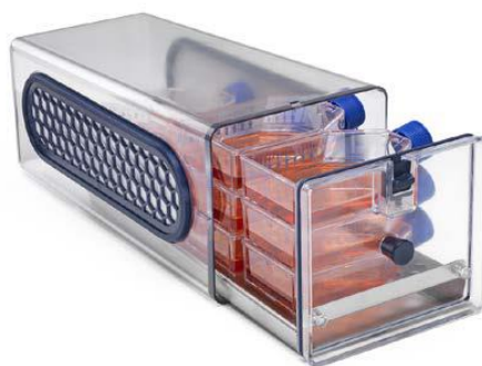
図 2: 各セルロッカーチャンバーには、空気交換が可能で微生物の出入りを制限する 2 枚の 0.2μm メンブレンフィルターが備わっています。チャンバーには、9 個の T-75 フラスコまたは最大 28 枚のマイクロウェルプレートが設置できます。
