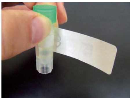
超低温耐性ラベルにRFIDタグを包埋
