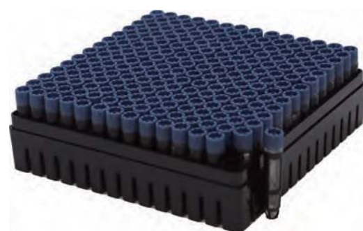
底面から二次元バーコードの読取が可能
