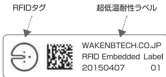
超低温耐性を保証するRFIDタグ包埋ラベル
