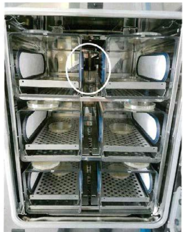
図.4A : ネブライザーの設置位置。背面左上のアクセスポートを通してチューブを接続しています。
