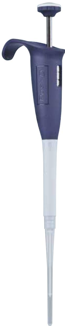
密度や粘性、蒸気圧の高いサンプル（洗剤、PEG、クロロフォルム、アルコール、血清など）取り扱いにくい液体でも信頼性の高いピペティングを実現します。使い捨てのキャピラリー／ピストンがクロスコンタミネーションを排除します。
